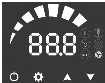
Рис. 14 Панель управления насосной установкой AQUAMASTER
